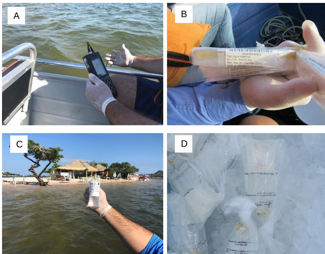
Figura 2. Procedimento de coleta de amostra durante o Monitoramento da Balneabilidade das Praias da Orla Fluvial direita do rio Tapajós no município de Santarém-PA. A) Medição do pH e da temperatura da água in loco B) Sacos estéreis para coleta do amostra C) Amostra coletada e devidamente etiquetada e D) Caixa térmica com gelo, utilizadas para conservação, armazenamento e transporte das amostras.
