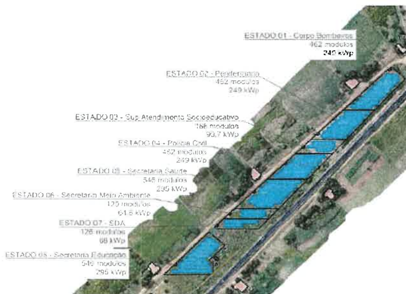
Figura 1 - Usinas fotovoltaicas para atender equipamentos públicos e a comunidade de Mandacaru
