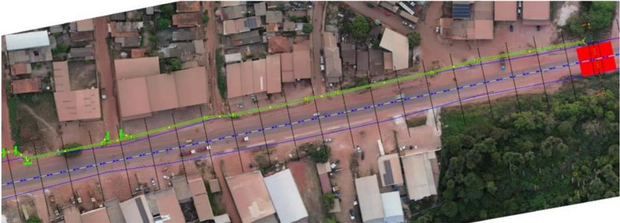
**Imagem 14:** Trecho que foi substituído a canaleta por tubulação
