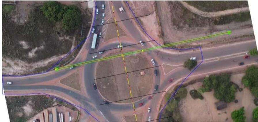
**Imagem 15:** Trecho que foi realizado uma drenagem de águas pluviais complementar com tubos de concreto para direcionar essas águas da canaleta da Av Moaçara atravessando a Av Cuiabá
